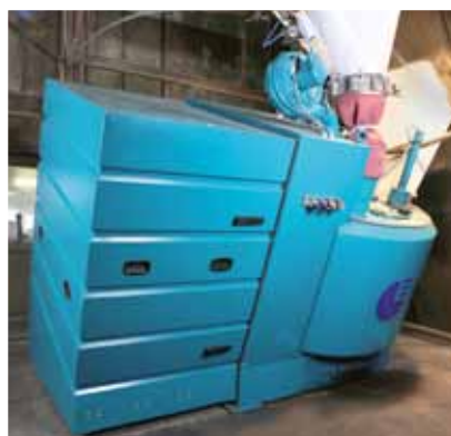
Types de mélangeur R12 / R19 / R24 / R28 pour la préparation de différentes formules de béton (dont certains remplacent des mélangeurs planétaires et à cuve annulaire)
