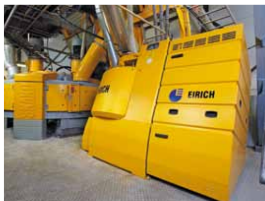
Types de mélangeur R12 / R19 / R24 / R28 pour la préparation de différentes formules de béton (dont certains remplacent des mélangeurs planétaires et à cuve annulaire)
