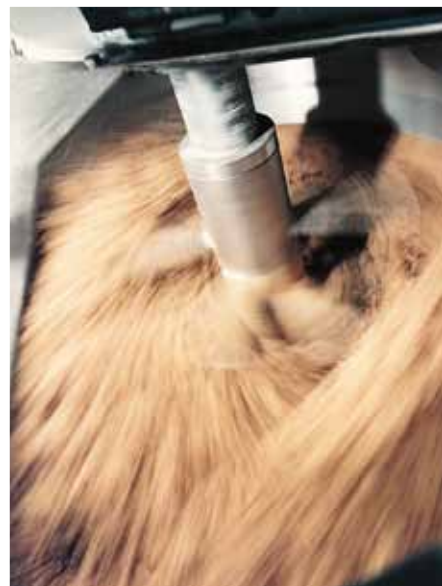
Flux de matière à mélanger dans le mélangeur EIRICH Les flux de matière sont générés de manière ciblée, pour des process de préparation planifiables
